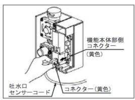
3. 機能本体部から接続エルボを外します。 ※小型のマイナスドライバーでリングを抜き取って下さい。
