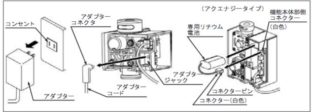
2. 吐水ロセンサーコードのコネクター(黄色)を外します。 ※コネクターが濡れないように注意してください。
